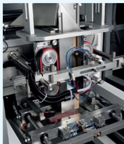
Particolare confezionatrice Welding area
